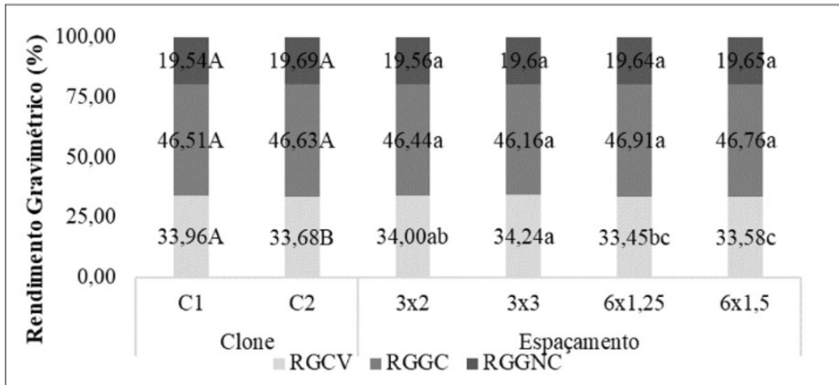
RGCV = Rendimento gravimétrico em carvão vegetal; RGGC = Rendimento gravimétrico em gases condensáveis; RGGNC = Rendimento gravimétrico em gases não condensáveis. As médias acompanham letras diferentes, com letras minúsculas entre os espaçamentos e maiúsculas entre os clones, isso indica diferenças significativas entre elas a um nível de significância de 5%, de acordo com o teste Tukey. C1= *Corymbia citriodora*; C2= *Corymbia torelliana*.
